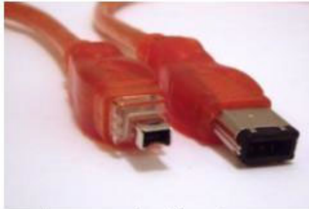
4-pinski (lijevo) i 6-pinski (dsno) FireWire konektori
